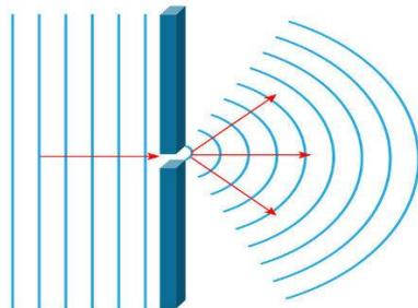
Difração: a fenda se comporta como uma fonte e a parede interromperá as ondas nas laterais.
